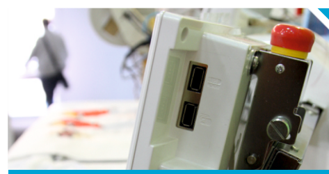
Возможность подключения компьютерной мыши
