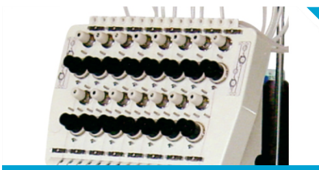
Сенсоры обрыва и окончания верхней и нижней нитей (автоматическая остановка при обрыве и окончании нити)
