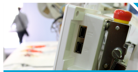
Возможность подключения компьютерной мыши
