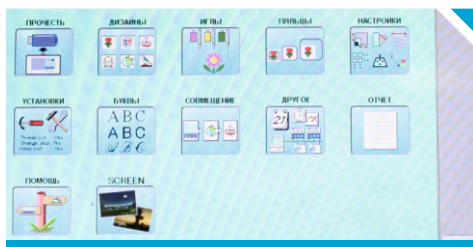
7 дюймовая сенсорная панель с удобным интерфейсом (10.4 дюймовая сенсорная панель как дополнительная опция)
